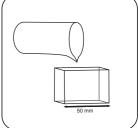
Encher a **célula de 50 mm** com **amostra**.
